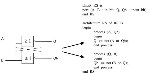
On suppose au départ que A et B = '0' avec Q = '0' et Qb = '1' puis B passe à '1'. L'exécution des deux process de l'architecture RS peut se représenter de la façon suivante :
