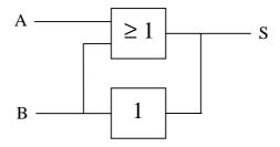
Or, pour qu'une telle description puisse être simulée il faut que le simulateur sache résoudre les différents cas possibles d'état du signal S. On peut par exemple se demander quelle est la valeur de S si la sortie de l'une des portes logiques est à '0' alors que l'autre est à '1'.
