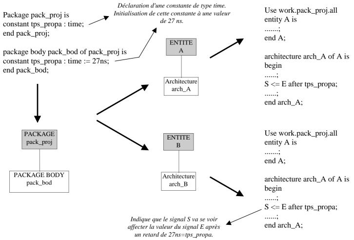
**□** La ligne de commande "use work.pack\_proj.all" qui se trouve en tête des déclarations des entités a pour but de prévenir l'analyseur ou le synthétiseur que l'on va utiliser des éléments du package pack\_proj, en l'occurrence la constante de type time tps\_propa initialisée à 27ns.
