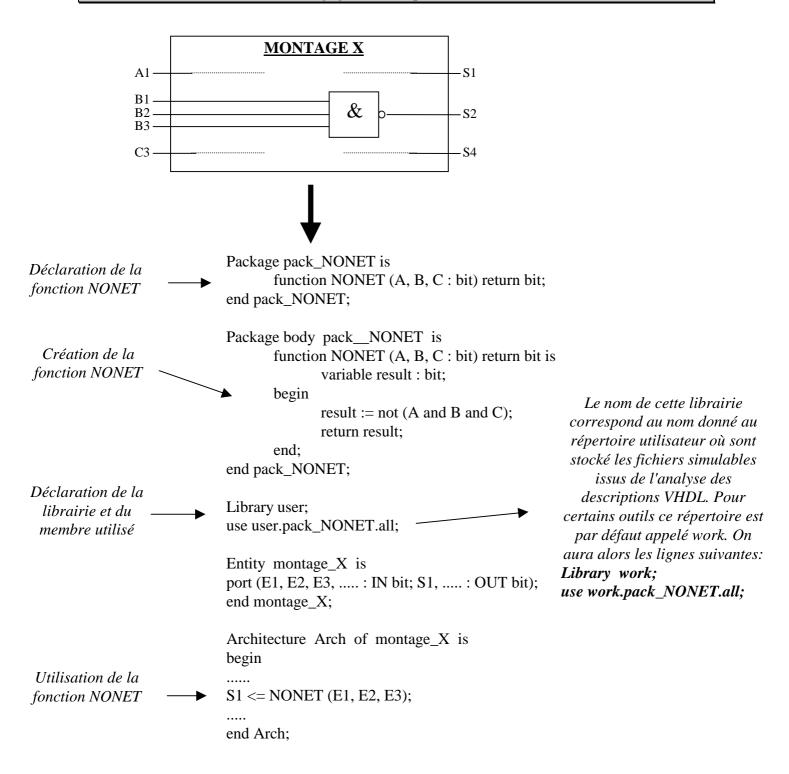
Notons que la fonction NONET déclarée dans le package est décrite dans le package body. Cette procédure est obligatoire et valable aussi pour les procédure :
