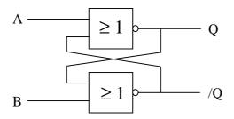
si le changement d'état de l'entrée A entraı̂ne celui de la sortie Q, alors le simulateur va calculer l'état futur de la sortie /Q et, si cela est nécessaire, calculer à nouveau l'état de Q, puis celui de /Q, etc., jusqu'à arriver à une situation stable. On peut résumer le fonctionnement du simulateur de la façon suivante :
